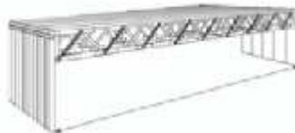
Le bâtiment à toit plat TP-3000, est constitué d'un entretoît et offre une portée libre intérieure. Sa toiture à pente légère assure un drainage.
