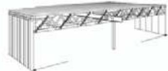
Le bâtiment à toiture plat TP-4000 possède les mêmes caractéristiques que le bâtiment TP-3000 et se distingue par l'ajout d'un système de support intermédiaire combiné aux fermes de toit HONCO pour augmenter la largeur du bâtiment.
